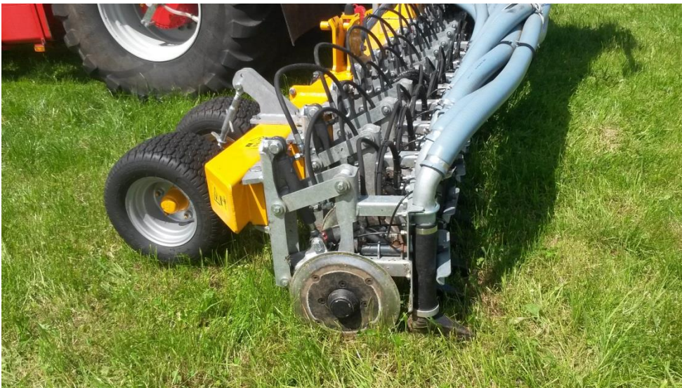
Bild 2: Beim Scheibeninjektor wird der Boden eingeschnitten und die Gülle direkt im Boden abgelegt.
