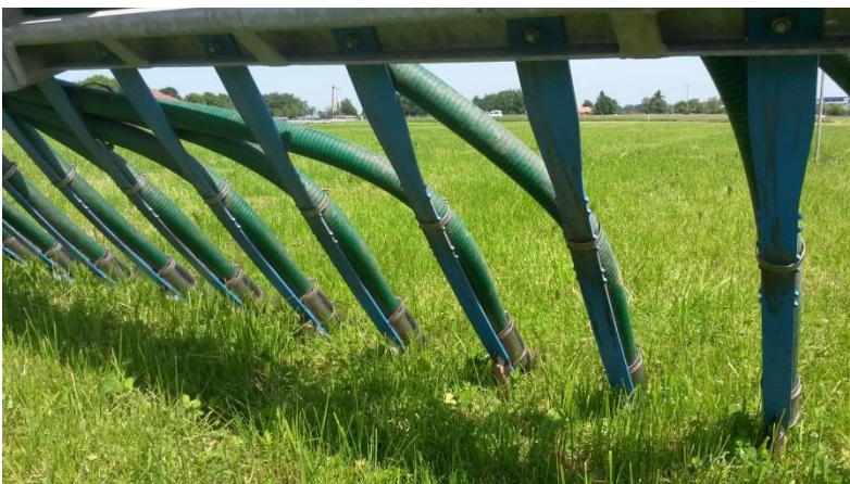
Bild 1: Beim Schleppschuhverteiler wird das Gras zur Seite gekämmt und die Gülle direkt am Boden abgelegt
